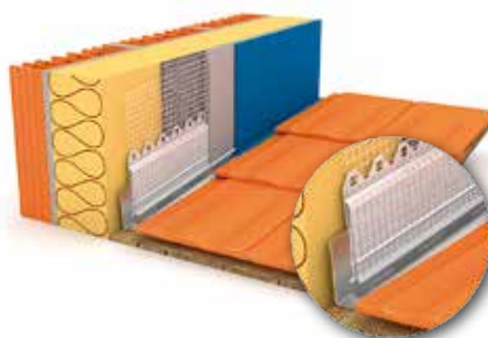
Ukončovací profil napojení oplechování k ETICS (F050-250)
